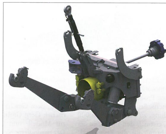
Die Länge bis zu den Kugeln in Arbeitsposition ist bei der Zuidberg-Lösung links um 26 mm kürzer.
