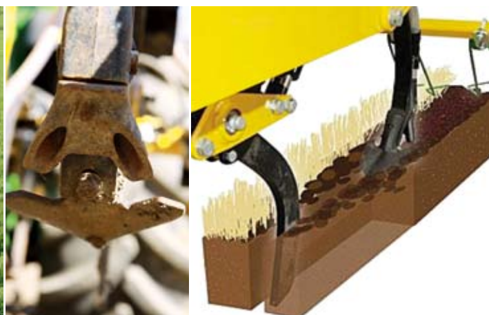
Saatgutablage Nach einem schmalen Meißelschar, das eine tiefe Furche zieht, folgt ein Gänsefußschar und legt neben der Furche die Saat ab.
